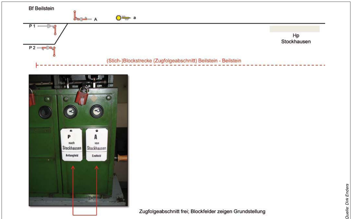
Abbildung 2a (oben) und 2b (unten): Blocktechnische Sicherung der Zugfolge im Vergleich am Beispiel des nichtselbsttätigen Streckenblocks Bauform C für eingleisige (Durchgangs-)Strecken und Strecken mit Stichstreckenblock
