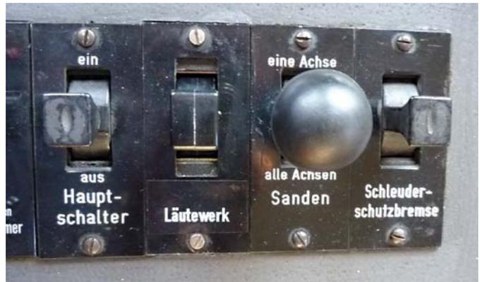
Bedienungseinrichtung einer Sandanlage an einer Einheitslok BR 141
