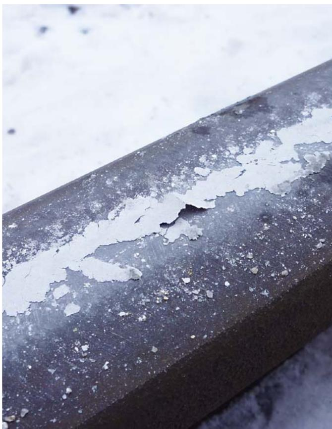
Sandfilm durch Sand nach Überfahren von mehreren Radsätzen
