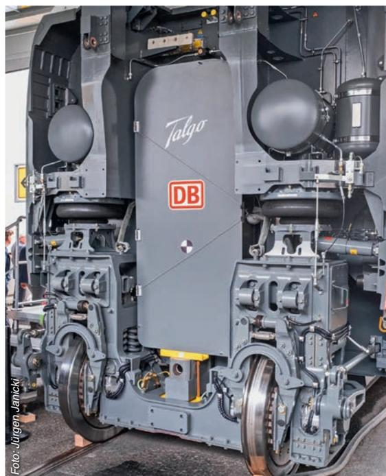
Spezielles Mittelwagen-Laufwerk des Herstellers Talgo für den ICE L
