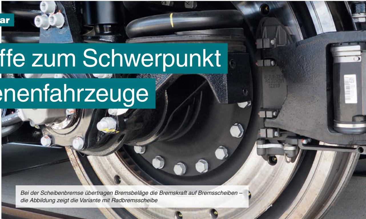
Bei der Scheibenbremse übertragen Bremsbeläge die Bremskraft auf Bremsscheiben – die Abbildung zeigt die Variante mit Radbremsscheibe
