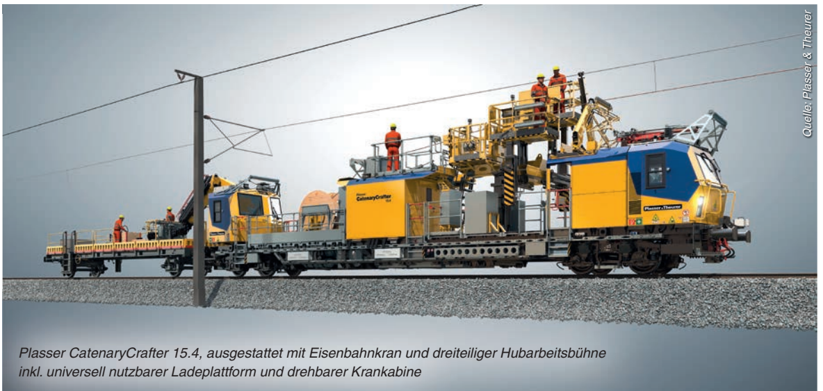
Plasser CatenaryCrafter 15.4 E 3 , ausgestattet mit Eisenbahnkran und frei verschwenkbarer Hubarbeitsbühne
