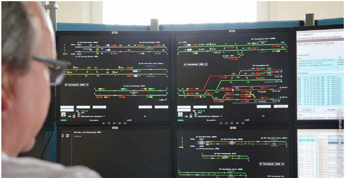
*Digitale Stellwerke (DSTW) stehen für die neueste Generation von Stellwerken. Stellbefehle werden digital über Hochleistungs-Glasfaserkabel an Gleise, Weichen und Signale übermittelt*
