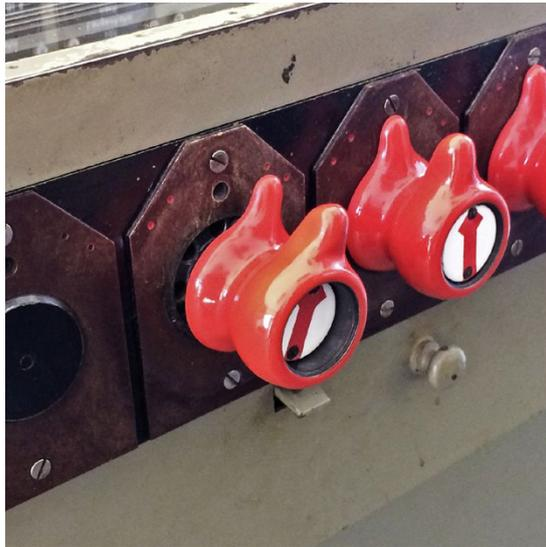
Abb. 8-13: Umstellvorgang des Fahrstraßensignalhebels A<sup>1</sup> (30°-Stellung; Weichenhebel mechanisch verschlossen) Foto: Dirk Enders
