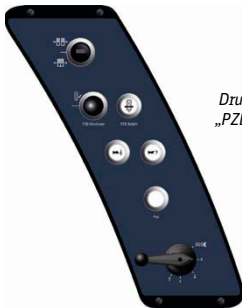
Abb. 4-4: Bedien- und Anzeigeelemente im Führerraum eines Eisenbahnfahrzeugs (Beispiel: Doppelstocksteuerwagen)
