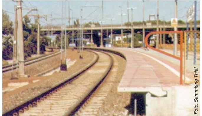
Abbildung 8: Bahnsteig mit klappbarer Bahnsteigkante (Bf Poznan-Torczyń)
