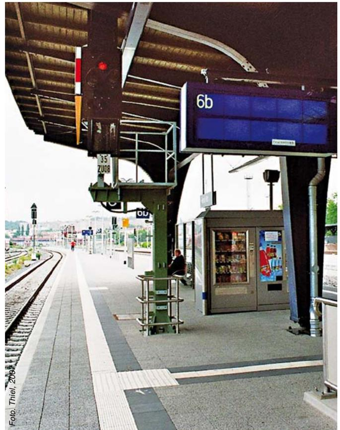
Abbildung 3: Konfliktfreie Lage von Blindenleitstreifen, Signal und Kabelschacht
