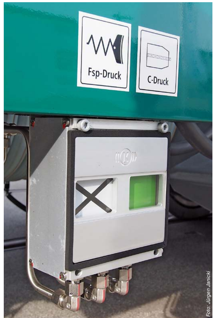
Bremsanzeigeeinrichtung eines Drehgestells an einem Triebwagen
