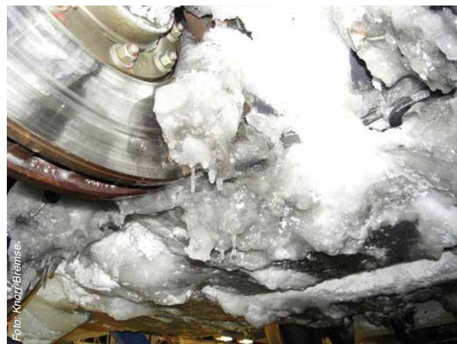
Abbildung 5: Scheibenbremse im Wintereinsatz in Russland
