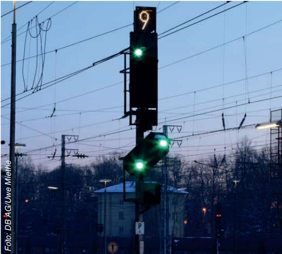
Beispiel für Zustimmung des Fdl zur Abfahrt (Fahrstellung des Hauptsignals)
