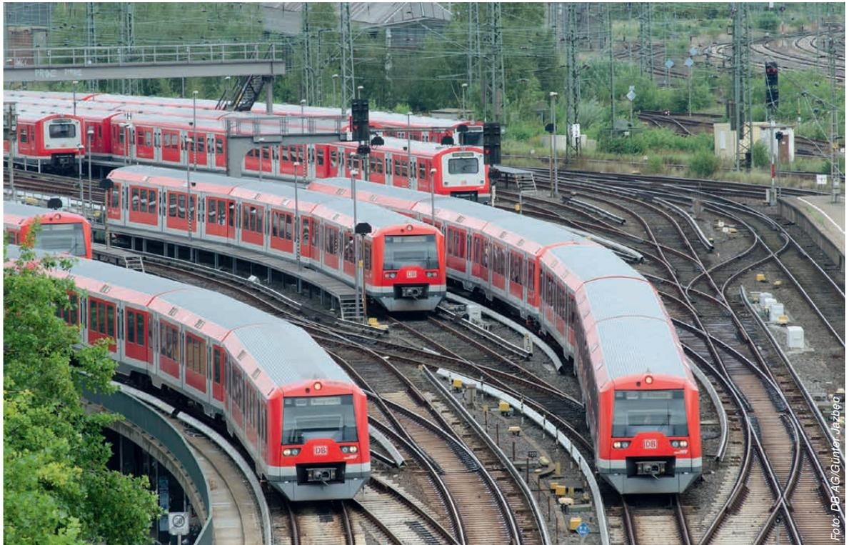
Triebzüge der Hamburger S-Bahn für den Betrieb mit Gleichstrom und Stromschiene
