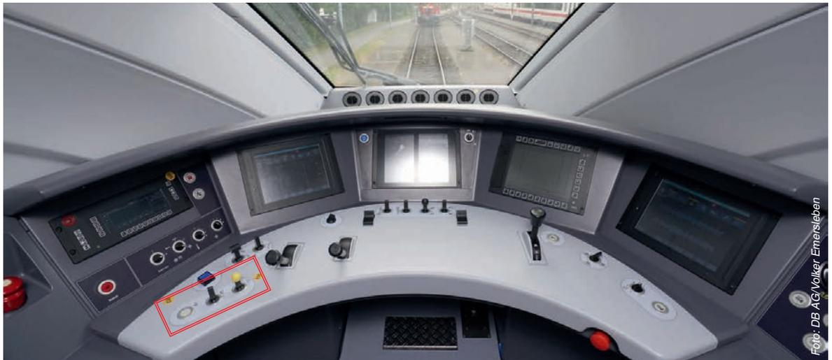
Führerraum BR 412 (unten links sind die PZB-Bedienelemente angeordnet)
