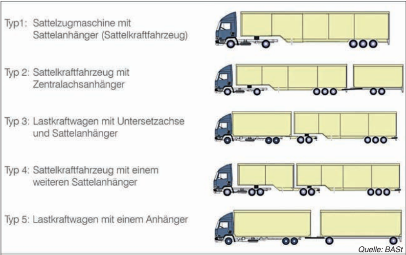
Abbildung 6: Mögliche Fahrzeugkombinationen nach der Verordnung über Ausnahmen von straßenverkehrsrechtlichen Vorschriften für Fahrzeuge und Fahrzeugkombinationen mit Überlänge (LKWÜberlStVAusnV)
