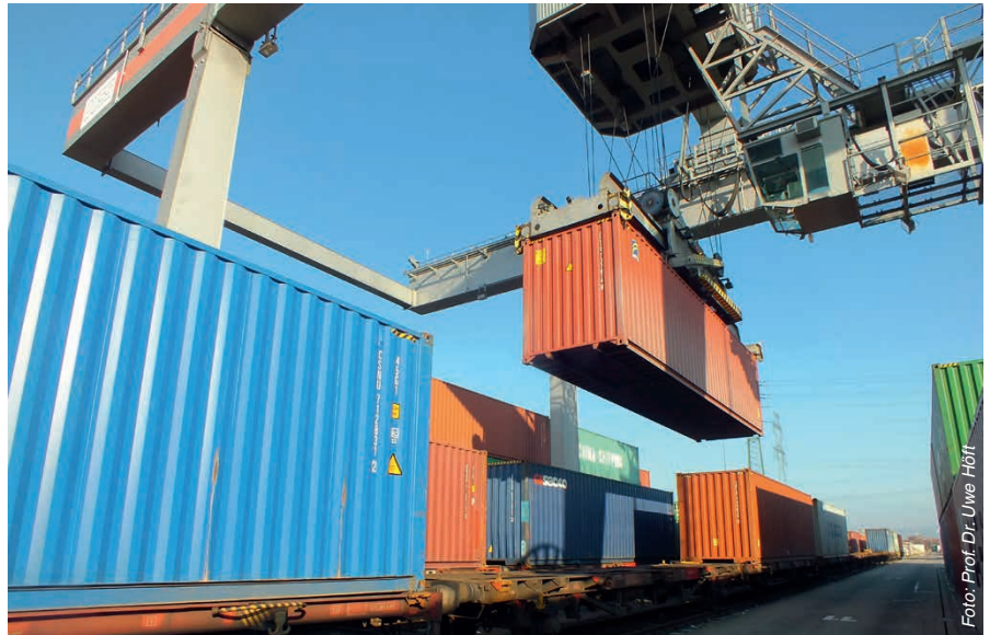
Abbildung 9: Umschlag mit einem Portalkran in einem KV-Terminal
